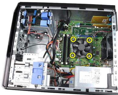
5. 輕輕抬起散熱器/風扇組件，然後從系統取出。放置組件時，請將風扇以及塗有散熱膏的一面朝上。
