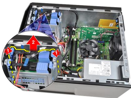
5. 鬆開硬碟機托架，然後將硬碟機從托架卸下。
