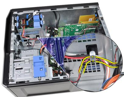
5. 將熱感應器輕輕從機箱前側撬開卸下。
