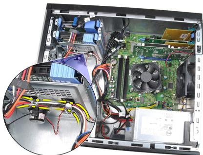
5. 將 24 插腳電源線從主機板拔下。
