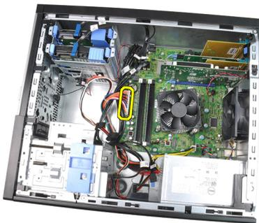
6. 將 4 插腳電源線從主機板拔下。
