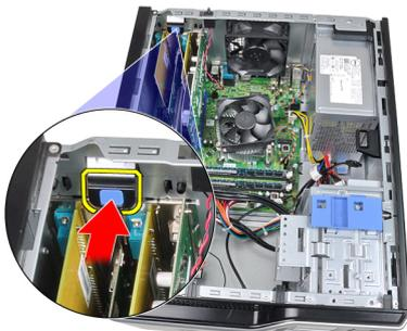
4. 從 PCIe x16 卡輕輕拉起釋放拉桿，直到從插卡凹口釋放固定彈片。然後將插卡從連接器輕輕拔出並從系統取下。
